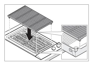
5 フレームを所定の位置に置きます。フレームが水平になっており、 フレームとグリッド間の隙間がすべて同じ距離になっていることを 確認します。
