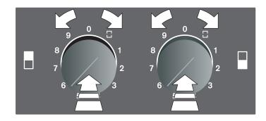
製品の加熱中は発光リングが白からオレンジ色になります。設定温度 に到達すると信号音が1回鳴ります。火力設定「9」の予熱は約10分 です。
