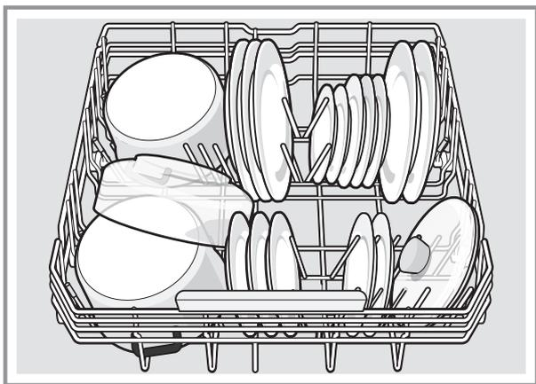
直径31cmまでの皿を下段バスケットにイラストのようにセットできます。
