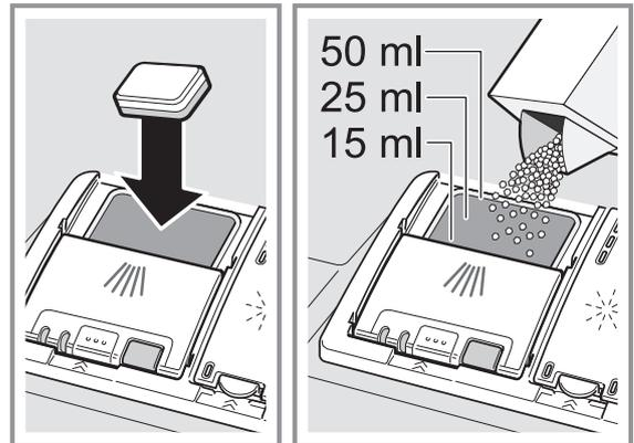
タブレットを使用する場合は、大きなタブレットは1つで十分です（小さいタブレットは3つ必要）。大きなタブレットは横向きにセットしてください。
