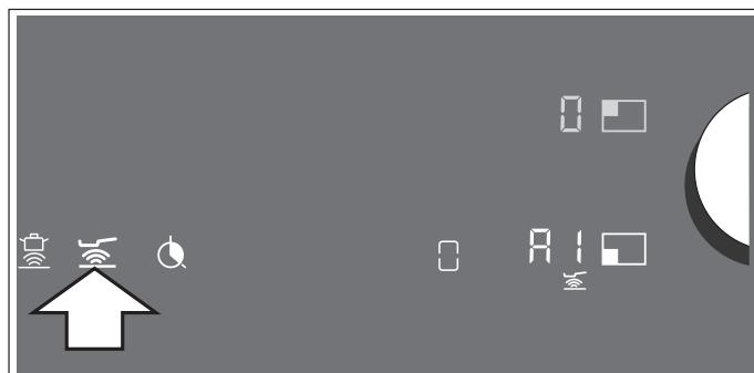
をタッチするか、ツイストノブを回して温度設定を  $\text{L}$  に合わせます。シグナル音が鳴り、
