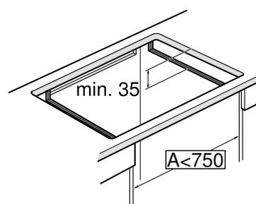
下部キャビネットのワイド有効寸法が750mm以下の場合、両側板上部にH35mm(min.)の切り欠きを設けてください。
