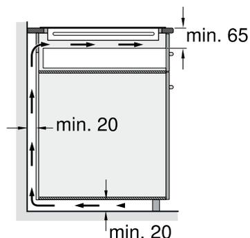
IHクッキングヒーターは内部装置を冷却するためにファンが組み込まれています。
