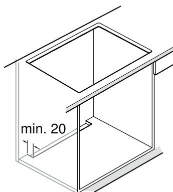
キャビネットの底板にD20mm(min.)の通気口を設けてください。
